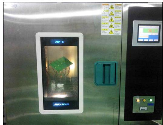
그림 2. 항온 챔버에 설치 완료된 마이크로 퓨즈
