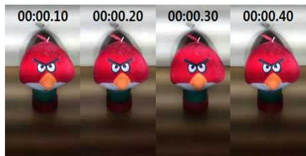
그림 14. 300Hz PWM으로 50% 조도제어 시 CMOS 카메라로 촬영한 플리커 이미지 Fig. 14. Image taken by the CMOS camera at 50% luminous intensity controlled by PWM control with 300Hz
