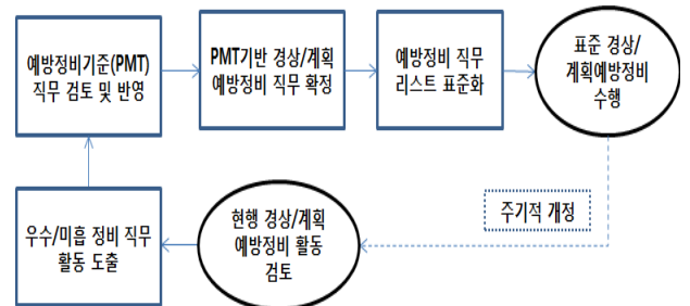
그림 9 예방정비 프로세스 최적화 Fig. 9 The process of preventive maintenance optimization (PMO)
