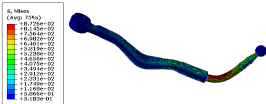
Fig. 4. Buckling Analysis Result of OTR
