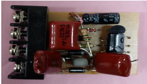
그림 5 제작한 결상보호기 외형도 Fig. 5 Photographs of manufactured OPP
