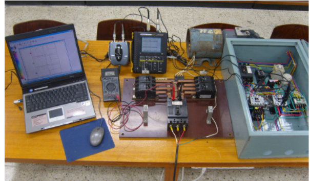
그림 6 동작성능 분석을 위한 실험장치 Fig. 6 Experiment set for operation performance analysis
