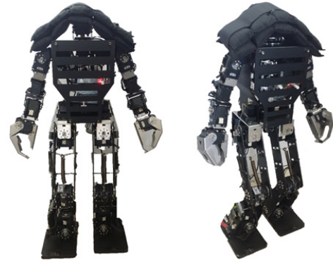
그림 8 상체에 하중을 부여한 로봇자세 Fig. 8 Robot posture with load on the upper body
