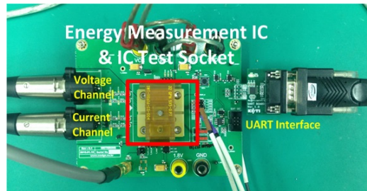
그림 12. 에너지 측정용 IC 테스트 보드 Fig. 12. Energy measurement IC test board
