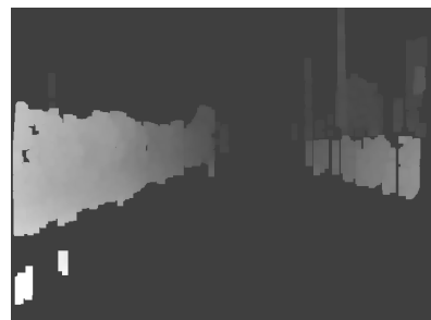
그림 3. U-시차 지도를 사용해 도로면을 제거한 영상 Fig. 3. Image removing the road surface using U-disparity map
