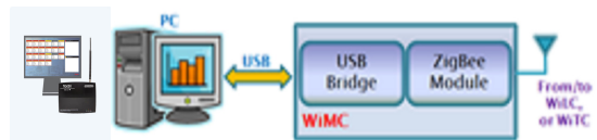
그림 5. WiMC 기능 블록도 Fig. 5 Functional block diagram of WiMC
