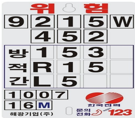
그림 1. 전주 번호찰 Fig. 1 Name plate of pole
