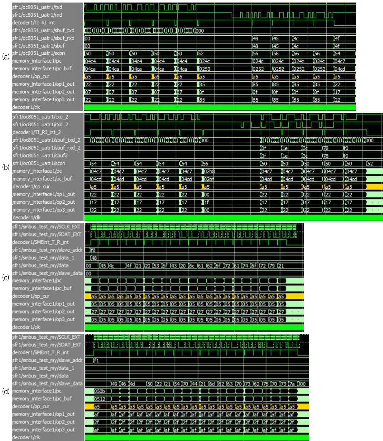
Fig. 6. Simulation waveform (a) UART0 (b) UART1 (c) SMBus Tx (d) SMBus Rx 그림 6. 시뮬레이션 파형 (a) UART0 (b) UART1 (c) SMBus Tx (d) SMBus Rx
