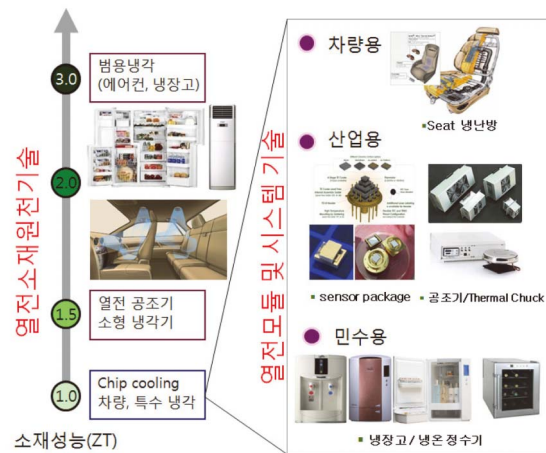
Fig. 6. Peltier 효과를 이용한 열전소재의 성능지수에 따른 열전 냉각 모듈 및 시스템의 응용분야.
