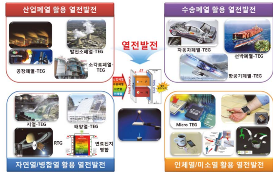
Fig. 7. Seebeck 효과를 이용한 열전발전 응용.
