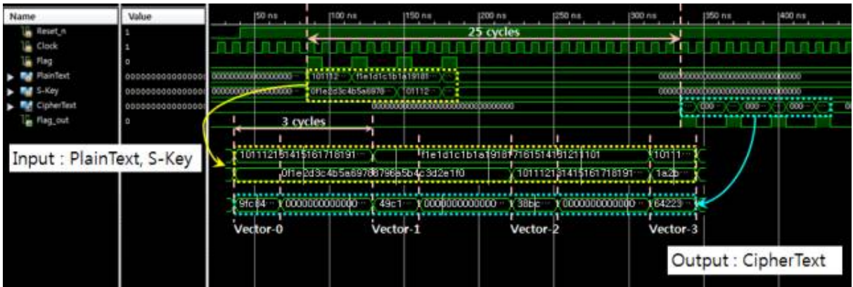
그림 11. 8단계 파이프라인 LEA-128 암호화 블록 시뮬레이션 결과
