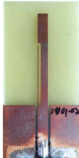
그림 7. 제작된 안테나 Fig. 7. Fabricated antenna.
