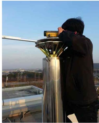
그림 20. 배열안테나 설치 각도 측정 과정
