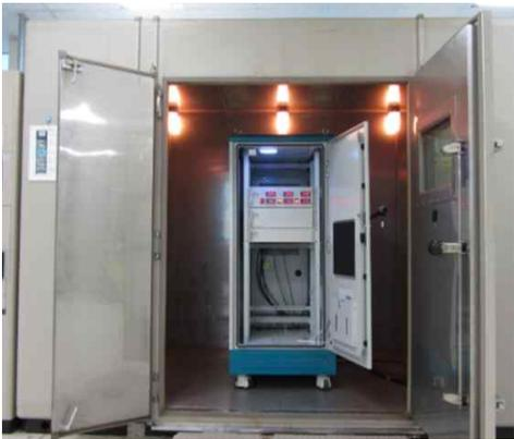
그림 13. 온도 챔버 시험 환경
