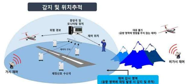
그림 1. GPS 전파위협원 위치추적 시스템 구성
