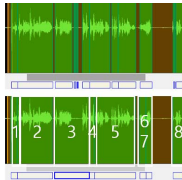
그림 3. 음성구간 추출(상단)과 발화구간 예측 후(하단)의 모습 Fig. 3. Extracting voice boundaries(top) and result of predicting utterance boundaries(bottom)
