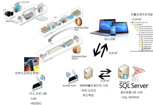
그림 2. Swing 컴포넌트를 이용한 인터넷 기반 공정관리시스템 Fig. 2. Internet-based process control system using Swing Components
