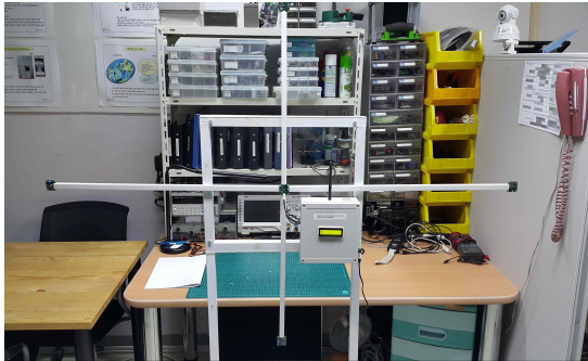
그림 7. 제작된 트리거 신호 검출 및 스마트폰 상대 위치 추정 시스템
