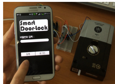
그림 7. 도어락 시스템 구현물 Fig. 7 Doorlock system implementation
