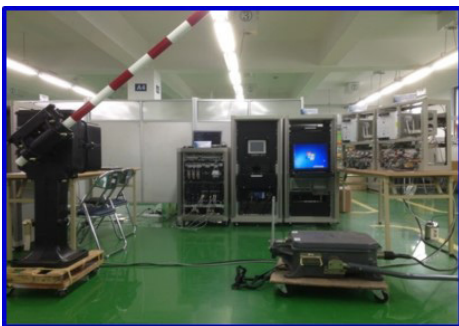
그림 6. 차상중심 열차제어시스템 테스트베드
