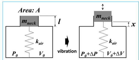
그림 2 질량-스프링계로 표현된 헬름홀츠 공명기( $P_0(V_0)$ : 평형 상태에서의 압력(부피))
