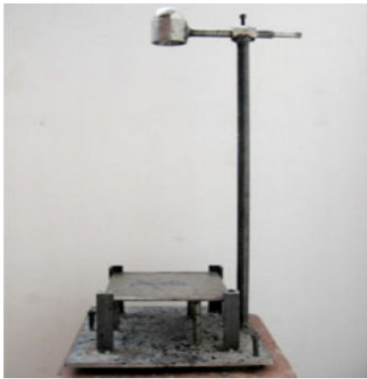
Fig. 8 Vialit Test Apparatus
