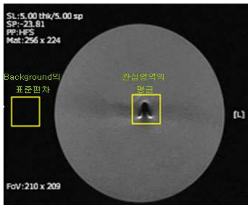
그림 6. 신호대 잡음비 측정 Fig. 6. Measure of the SNR
