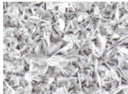
그림 1. Brushite의 현미경 영상 Fig.1. Brushite microscope image
