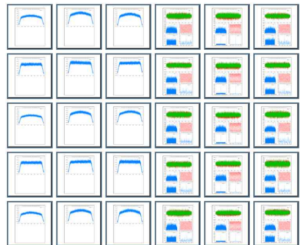
그림 8. 상관처리 실험에 사용된 r14056b의 상관처리 결과 이미지(좌측 3열: 자기상관스펙트럼, 우측 3열: 상호상관스펙트럼과 프린지) Fig. 8. Correlation result image of r14056b used in correlation processing experiment(left 3 column : auto correlation, right 3 column : cross correlation and fringe)
