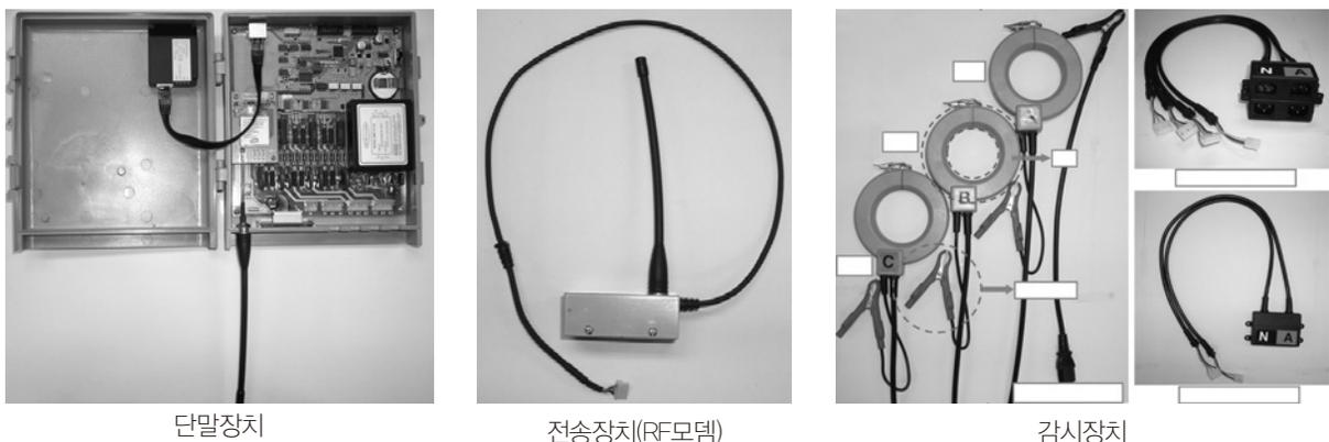
[그림 1] 변압기 무선부하 감시 시스템 구성
