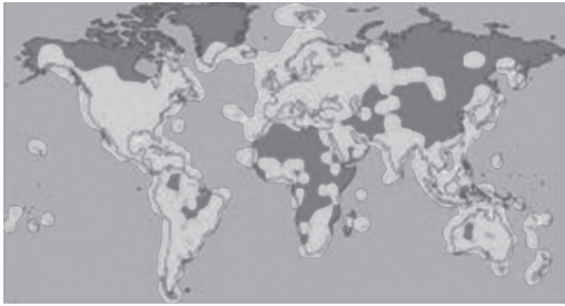
[그림 1] 지상 ADS-B 시스템의 항공기 감시 영역
