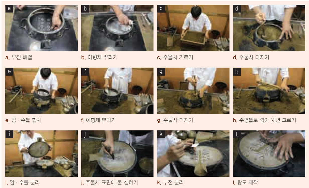
【 사진 3 】 본기쇠틀을 이용한 거푸집 만들기
