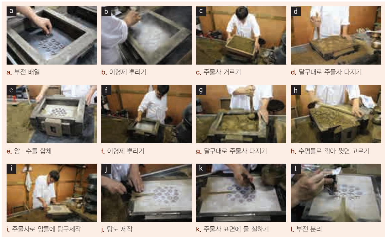
【 사진 5 】 본기목틀을 이용한 거꾸집 만들기
