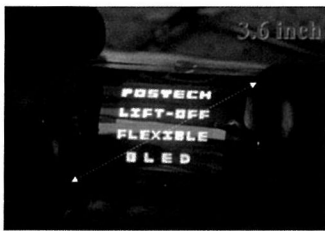
▶▶극평탄 금속기판 제조기술을 이용해 만들어 시연한 3.6인치 플렉서블 OLED 사진
