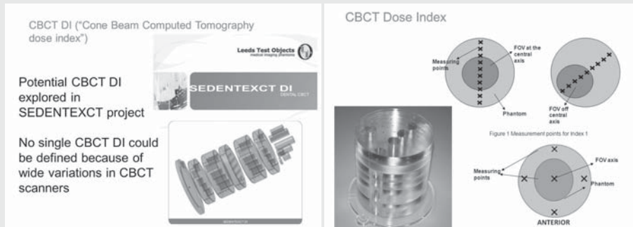
그림 5. 다양한 조건을 갖는 CBCT장치의 CTDI를 측정하기 위해 고안된 팬텀과 측정방법
