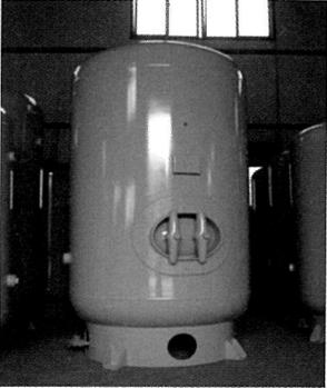
압력용기란 내외부에서 일정한 유체(액체, 기체)압을 받는 용기를 말하며 내압 외 진공압을 받는 용기도 압력용기에 포함되고, 보통 형상에 따라 탱크(TANK), 홀더(HOLDER), 드럼(DRUM), 컬럼(COLUMN)으로 구분된다.
