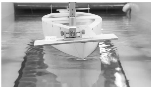
Fig. 10 Wave pattern( \phi=5^\circ , 2knots)
