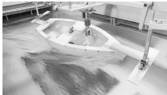
Fig. 14 Wave pattern( \phi=5^\circ , 6knots)
