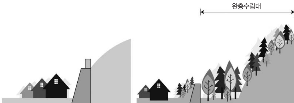
그림 2. 토목적인 방법에 의한 옹벽공(좌)과 완충수림대의 개념도(우)
