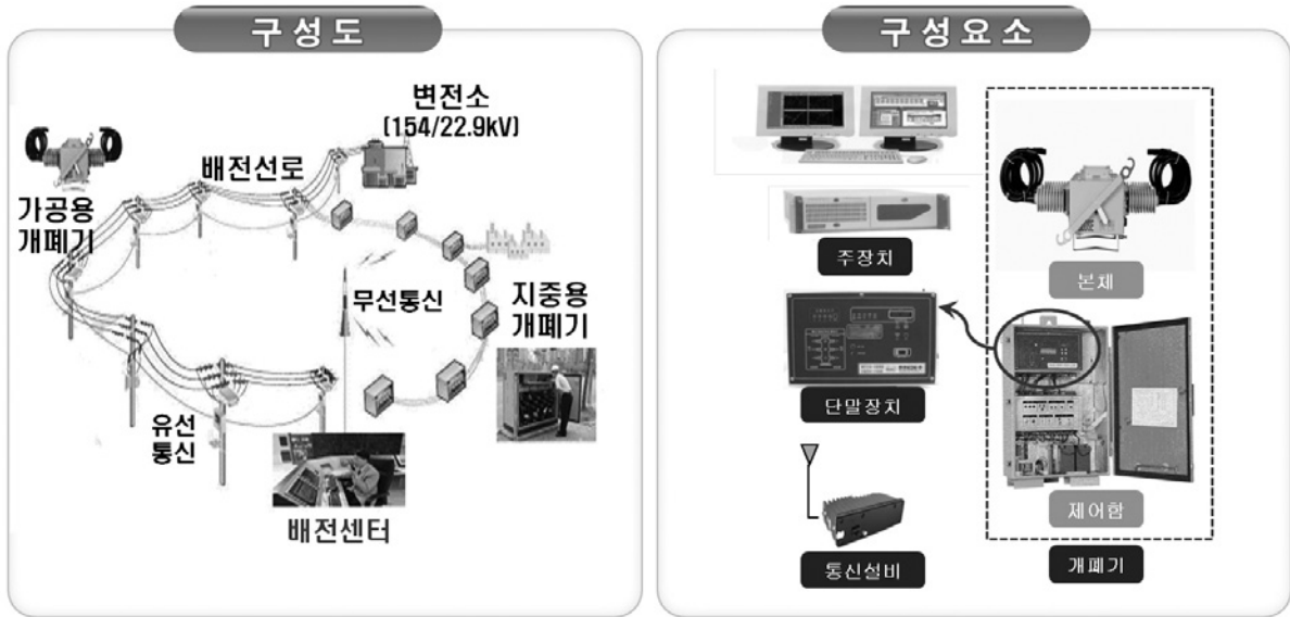
[그림 1] 배전지능화 시스템의 구성도 및 구성요소
