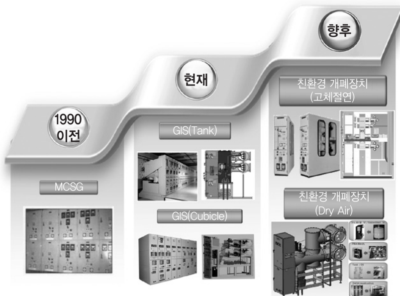
[그림 1] 25.8kV 개폐장치 개발 추이
