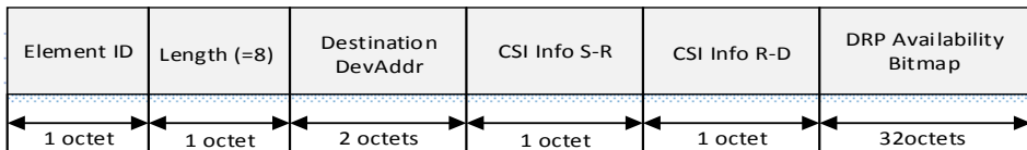
그림 4. Relay Response IE의 구조 Fig. 4. The format of Relay Response IE
