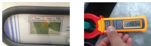
그림 12 차단기 동작전 LCM 정상동작여부 확인(차단기 닫힘)
