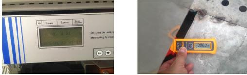
그림 13 차단기 동작후 LCM 정상동작여부 확인(차단기 개방)
