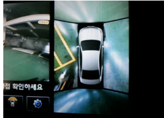
그림 4. 영상정합 알고리즘을 이용하여 4개의 영상을 합친 영상 Fig. 4 The image which combines 4 images using the image registration algorithm
