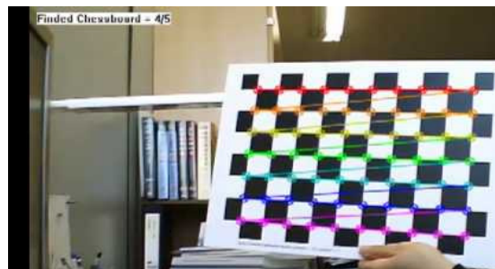
그림 1. 좌표를 구하기 위한 칼리브레이션 기법 Fig. 1 Calibration technique for setting coordinates
