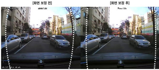
그림 2. 왜곡보정 전, 후 영상 Fig. 2 Before and after distortion compensation
