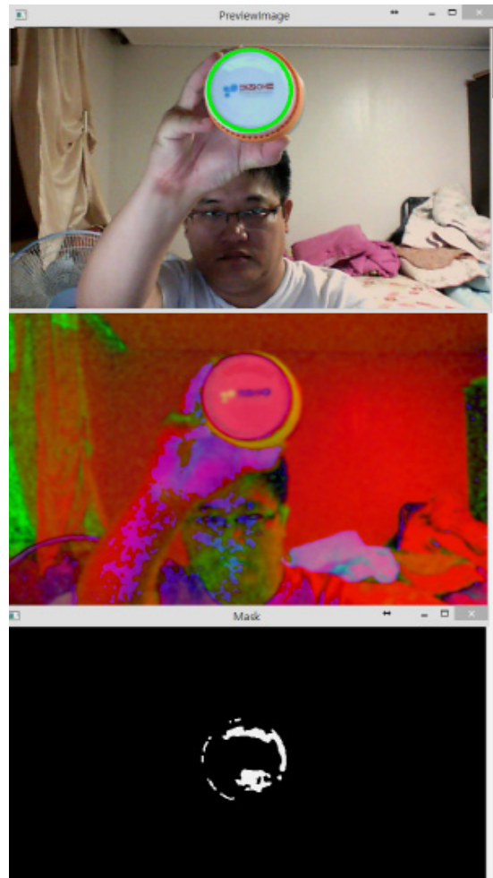
그림 2. 지정한 색상의 원모양만 검출 Fig. 2 targeted color circle detection
