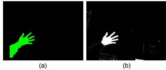
그림 6. 깊이영상과 피부색영상으로부터 손 검출결과 (a) 검출된 깊이영상 (b)피부색검출영상 Fig. 6 Immediate Result of Hand Detection from Depth and Color Images (a) Detected Depth Image (b) Result of Skin-color Detection
