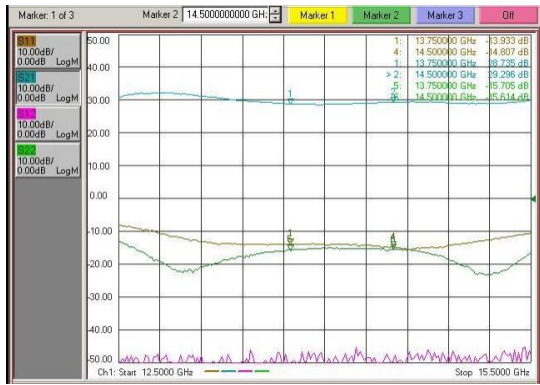
그림 5. 제작된 Ku 대역 2W MMIC 전력증폭기의 S-parameters 측정결과
