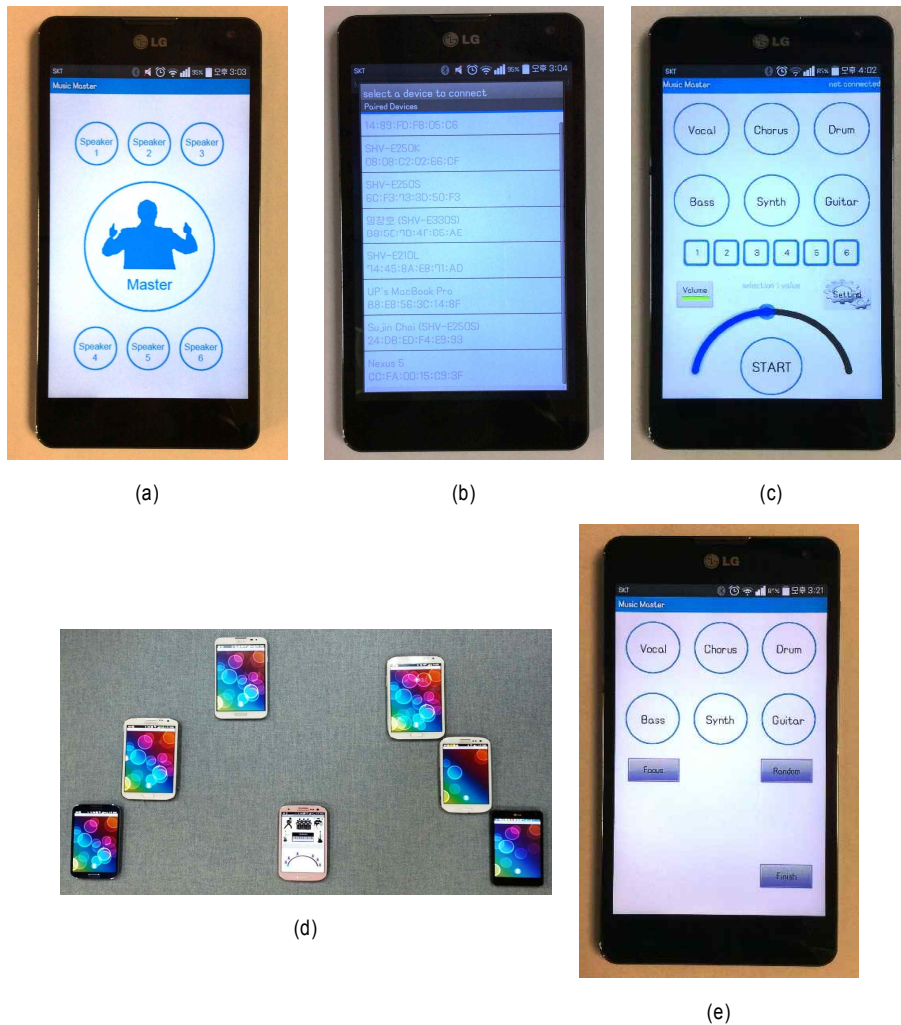
그림 6. 개발한 시스템의 스마트폰 응용 프로그램의 화면 구성; (a) 마스터 또는 스피커 선택 화면, (b) 블루투스 기기 선택 화면, (c) 마스터 기기 조정 화면, (d) 전체 시스템의 동작 화면, (e) 마스터 기기의 추가 기능 선택 화면 Fig. 6. Screen of smartphone applications in the developed system; (a) Screen for selection between master and speaker, (b) Screen for bluetooth device selection, (c) Master control screen, (d) Operation of the entire system, and (e) Screen for extra feature in master
