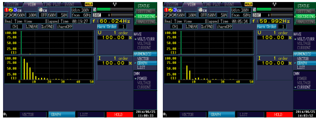
(a) 부하 9kW (변압기 삽입 전) (b) 부하 9kW (변압기 삽입 후)
