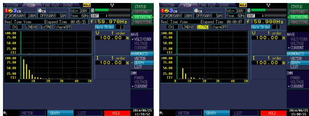
(e) 부하 18kW (변압기 삽입 전) (f) 부하 18kW (변압기 삽입 후)
