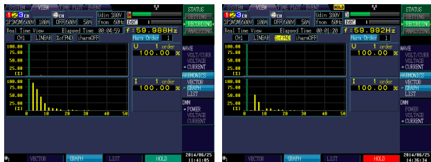
(c) 부하 15kW (변압기 삽입 전) (d) 부하 15kW (변압기 삽입 후)
