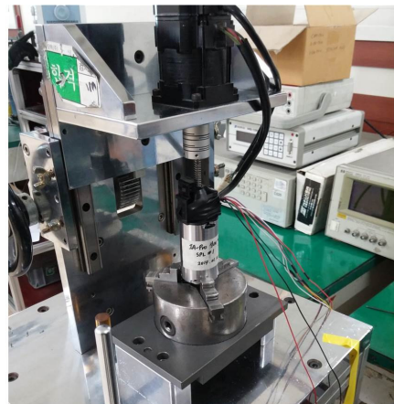
그림 9 역기전력 측정 시험장비 Fig. 9 Test equipment for measuring Back-EMF
