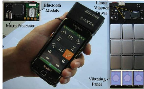
그림 1. 진동 촉각 패드 장치, T-Mobile.
