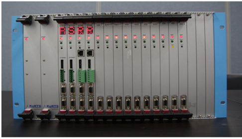
그림 1. 개발된 FPGA 기반 제어기 Fig. 1 Developed FPGA-based controller
