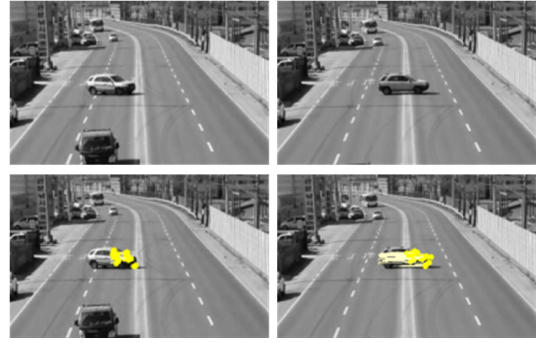
그림 12. 불법 유턴 차량과 불법 유턴 경로 상의 움직임벡터 Fig. 12. Illegal U-turn vehicle and motion vectors on illegal U-turn path
