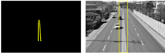
그림 5. 이진화된 중앙선 이미지의 진보된 확률적 허프 변환 Fig. 5. Progressive probabilistic hough transform of binarized Center Lane image
