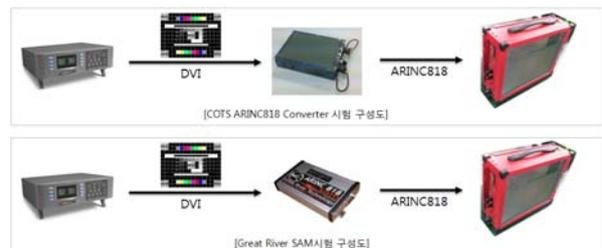
그림 6. ARINC 818 converter 시험구성도
