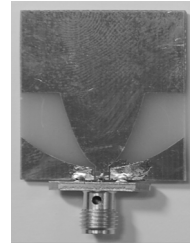
그림 2. 불연속 CPW로 급전한 안테나의 실물 사진 Fig. 2. Photograph of fabricated antenna fed by discontinuous CPW
