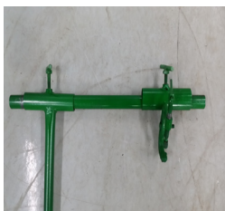
(d) Welding Jig
