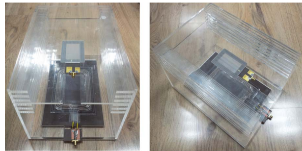
Fig. 10. 제로 굴절률을 갖는 메타materi얼이 없는 무선전력전송 제작물
